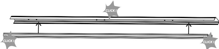
**PL** Aby uzyskać IP40 należy połączyć zakupiony panel nośny z profilem led lub maskownicą
